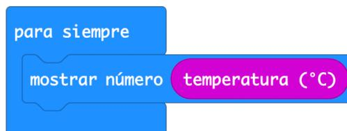
3. ¿Qué esperas que pase cuando lo ejecutes? Verifica en el simulador y sobre la **Micro:bit**; se trata de un **bucle** que se repite siempre. Igualmente estás utilizando una nueva entrada, la **temperatura**. Este es un nuevo tipo de variable que no es **booleana**, sino una **variable numérica** que contiene la temperatura que mide el procesador de la **Micro:bit**.
